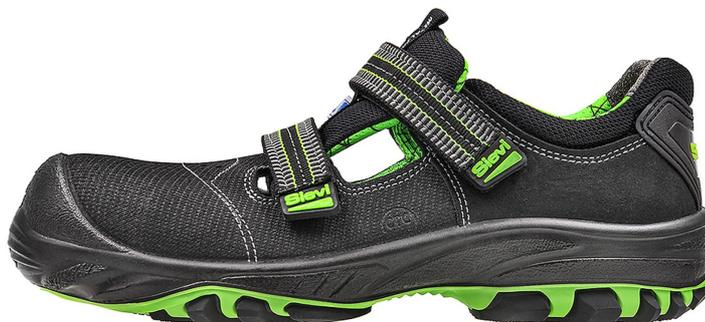
Спортивные сандалии (полуботинки) с композитным внутренним защитным носком и с изготовленной из композитного текстиля проколзащитной прокладкой SieviSole-X. Улучшенный комфорт благодаря легкой застежке-липучке и дышащей подкладке 3D-Dry®, сохраняющей ноги сухими. Стелька Dual с двумя амортизационными вставками эффективно поглощает удары, снижая нагрузку на спину и ноги. Двухслойная подошва устойчива к истиранию, маслам и многим химикатам.
