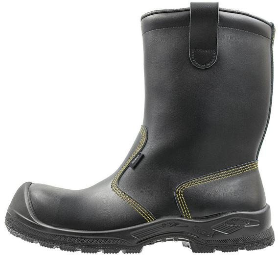
Chaussures montantes fabriquées dans du cuir enduit de PU résistant et déperlant. Languette à l'arrière de la chaussure pour aider à l'insertion du pied. Protection des orteils en composite et protection antiperforation en acier. Les semelles souples en polyuréthane donnent une excellente traction et résistent à l'huile et autres produits chimiques. Homologation ESD.
