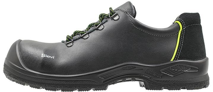
Chaussure basse à lacet en cuir revêtu PU durable. Protection des orteils en composite et antiperforation en acier. Semelle d'usure double en polyuréthane résistante à l'huile et à de nombreux produits chimiques et amortissant efficacement les chocs. Semelle intérieure amovible profilée aérée et doublure 3D-dry® améliorant l'aération et par-là le confort. Approuvé ESD.
