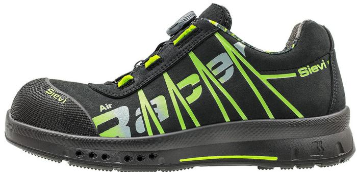
Halbschuh der Schutzklasse S3 mit SieviAir®-Sohle, BOA®-Schnellverschluss, Nageldurchtrittsschutz aus Stahl und Alu-Zehenschutz. Die hochmoderne FlexEnergy®-Fersenstoßdämpfung gibt mehr als 55% der kinetischen Energie an den Bewegungsapparat zurück. Die SieviAir®-Sohle hat seitliche Lüftungskanäle, welche die Feuchtigkeit der erwärmteten Füße nach außen ableiten.
