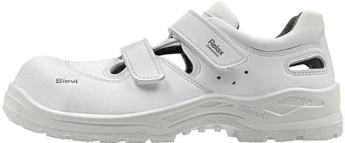
Weißer Mikrofaserschuh für hohe Hygieneanforderungen. Mikrofaser ist ein leichtes Gewebe, das häufiges Waschen aushält. Das 3D-dry® Futter ist atmungsaktiv und hält die Füße trocken. Klettverschluss für schnelles und einfaches Öffnen und Schließen. Dank Profil und PU Mikrozellenstruktur ist die Sohle sehr rutschfest. Antistatisch und ESD. Zertifiziert für orthopädische Einlegesohlen nach DGUV.
