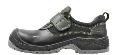
Aluminiumschutz im Zehenbereich und Nageldurchtrittschutz aus Stahl sowie schicke Überkappe an der Schuhspitze. Das Obermaterial besteht aus verschleißfestem Leder. Die graue Gummisohle ist verschleißfest und bis zu 300 °C hitzebeständig. Hitzebeständige Kevlar-Nähte. Zertifiziert für komplette Zurichtung nach DGUV.
